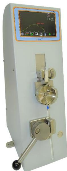
Der **Pulltester PT 1500** ist ein motorisiertes Messgerät zur Ermittlung von Auszugskräften bis zu 1500 N. Der exakt geregelte Antrieb ermöglicht ein konstantes, gleichförmiges Ziehen über den gesamten Kraftbereich und damit sehr genaue und reproduzierbare Messungen.
